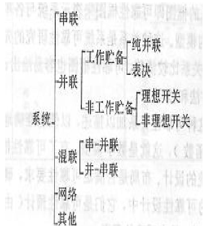
图 2.5 系统可靠性框图的分类
