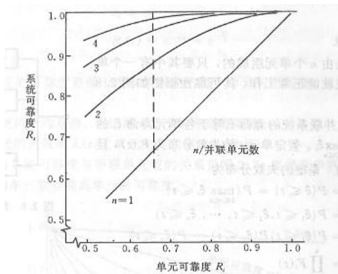
图 2.9 并联系统的可靠度与单元可靠度之间的关系
