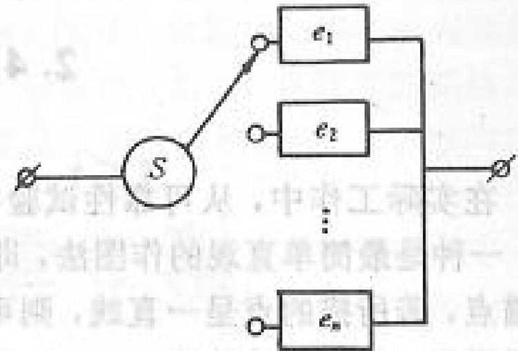
图 2.13 贮备系统的结构
