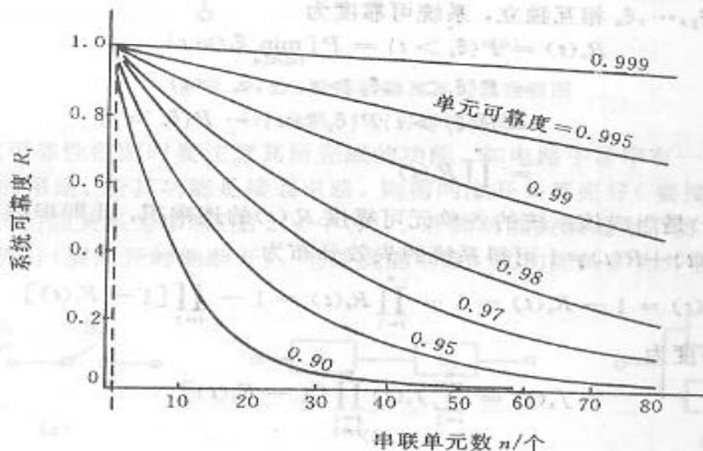
图 2.7 串联系统的系统可靠度与串联单元数关系
